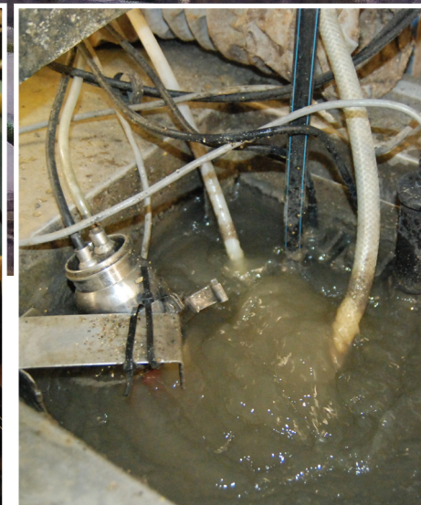
I Sjöstadsverkets testanläggning jobbar man med realistiska förutsättningar och samma vatten som går till det ordinarie, stora reningsverket Henriksdal. Men här handlar det om cirka 200 personers avlopp.
